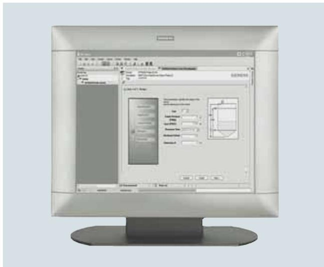
SITRANS DTM предоставляет пользователям приложений Field Device Tool (Инструмент полевых устройств) (FDT) и Device Type Manager (Менеджер типов устройств) (DTM) простой и легкий способ задания параметров приборов «Сименс» с соблюдением международных стандартов.
