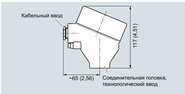
Соединительная головка, алюминий, тип AG0, нержавеющая сталь, тип AU0, размеры в мм (дюймах)
