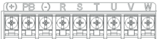
Рис. 3-6: Клеммы силовой цепи 3-фазного ПЧ от 4 до 22 кВт
