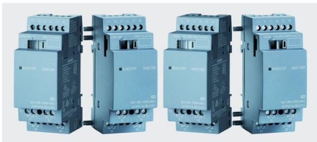
Модули расширения LOGO! DM выпускаются в пластиковых корпусах размерами 35.5x 90x 58 мм (DM8) или 71.5x 90x 58 мм (DM16) и имеют степень защиты IP20. На их корпусах расположены:
