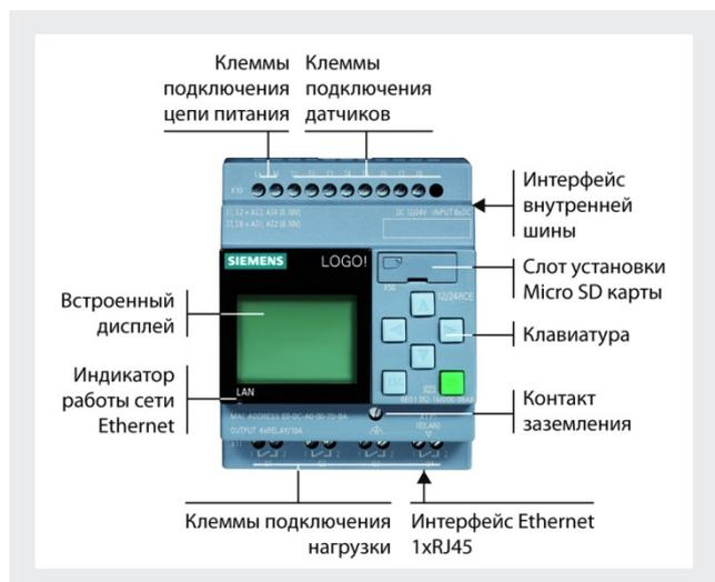
Логические модули LOGO! 0BA8 выпускаются в пластиковых корпусах размерами 71.5x 90x 60 мм и имеют степень защиты IP 20. Каждый модуль оснащен:
